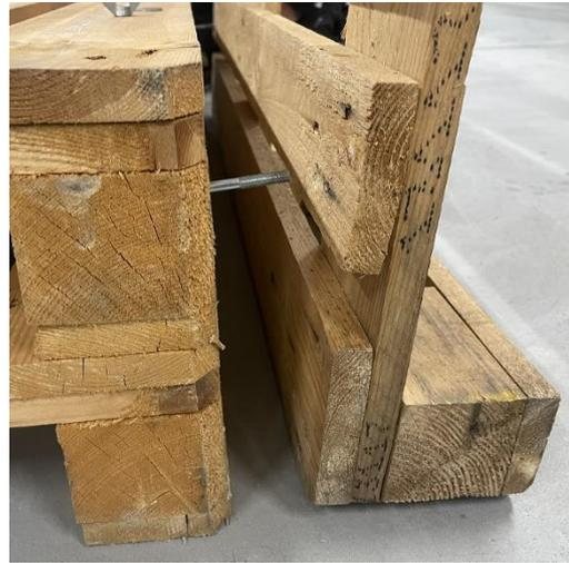
5. Die Rückenlehne mit den Unterlagsscheiben und Flügelmuttern an beiden Seiten fixieren.
